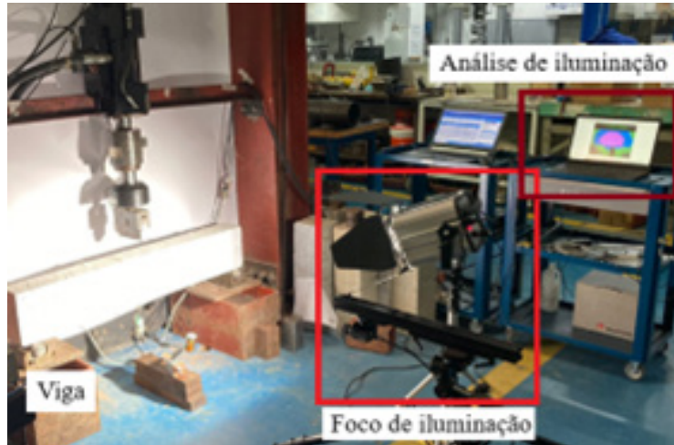
Figura 5 – Configuração para coleta de imagens para análise DIC
