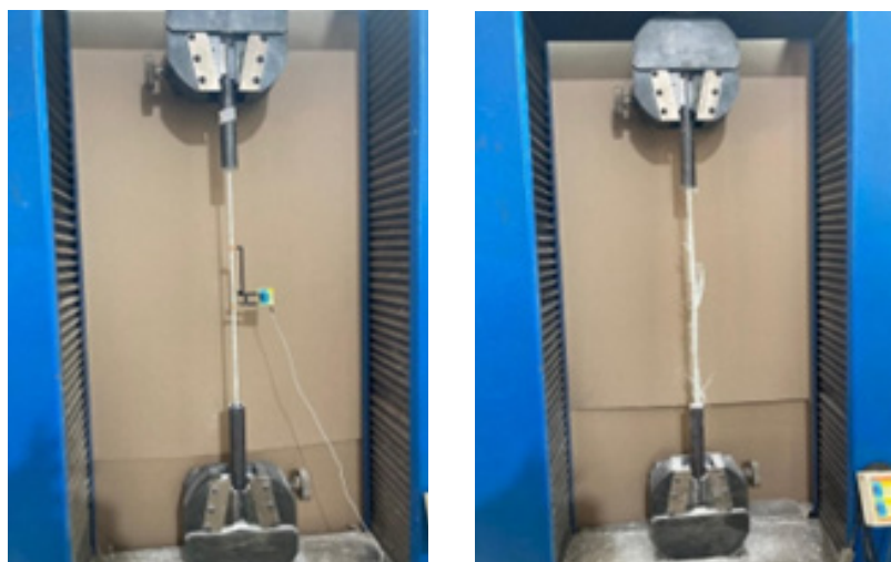
Figura 1 – Configuração e ensaio de tração
