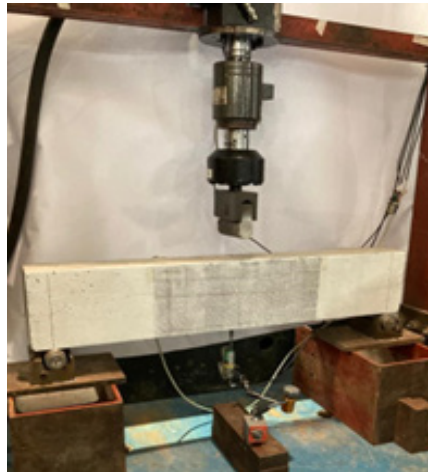
Figura 4 – Configuração do ensaio de flexão à três pontos
